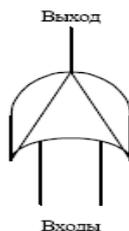
**Схема И с приоритетом**: логически эквивалентна схеме И, но входные сигналы должны поступать в определенном порядке
