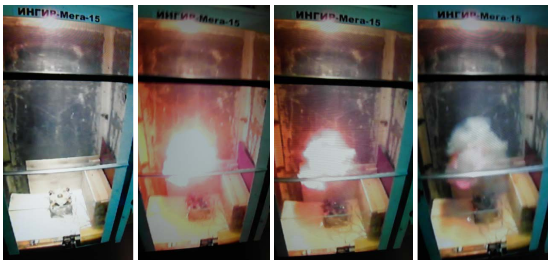
Рис. 2 – Выборочные кадры видеосъёмки процесса электровзрыва.
