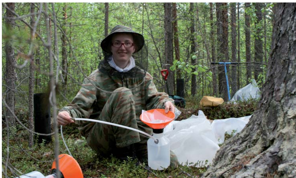
Рис. 4.10. (часть 1 и 2) Лизиметр и отбор почвенных вод (фото Н.В. Поликарповой).
