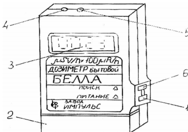
Рис. 3.4. Индикатор бытовой «Белла»: 1 – выключатель питания; 2 – крышка отсека питания; 3 – цифровое табло; 4 – кнопка “МЭД-контр.питания” для включения режима
