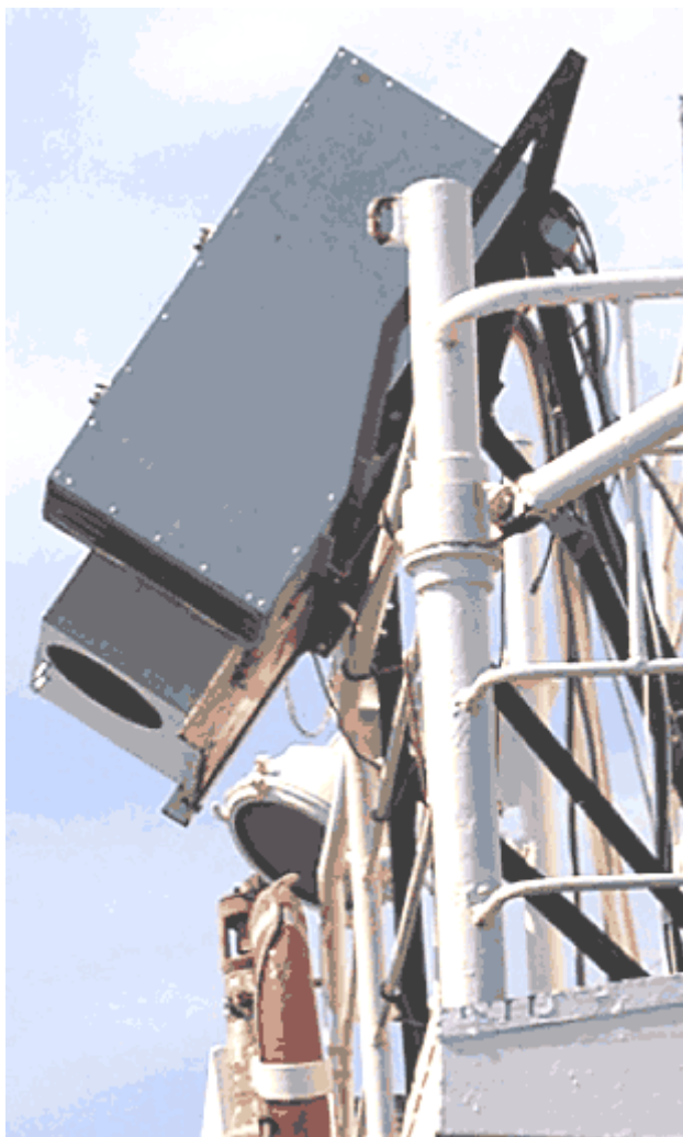
Рис. 1.3. Многофункциональный флуоресцентный лидар в судовом варианте
