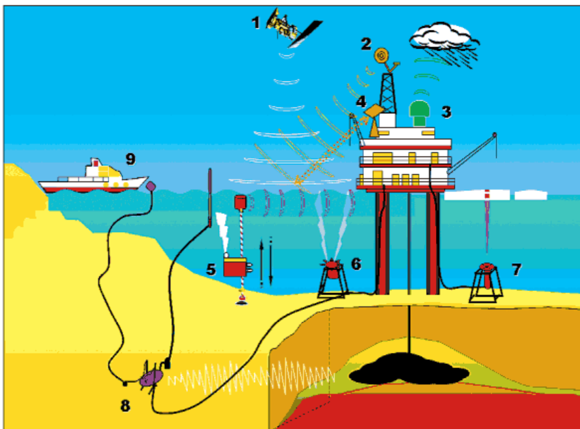
Рис. I.1. Многоуровневая структура измерительных средств системы экологического мониторинга для нефтедобывающих платформ на морском шельфе: 1 – искусственные спутники дистанционного зондирования Земли; 2 – радиолокатор кругового обзора; 3 – метеостанция; 4 – лидарный комплекс; 5 – подводный профилирующий зонд; 6 – измеритель волнения и уровня моря; 7 – сонар толщины морского льда; 8 – сейсмическая станция подсистемы геодинамического мониторинга; 9 – судовой комплекс мониторинга морской акватории. Измерители 2 – 4 устанавливаются непосредственно на платформе, измерители 6 – 7 – на дне.
