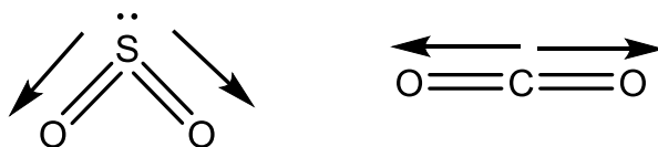
Рис. 1.4. Строение \text{CO}_2 и \text{SO}_2 (указаны направления дипольных моментов связей)
