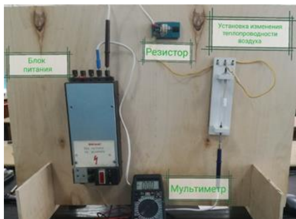
Рис. 2. Установка для измерения коэффициента теплопроводности воздуха и теплоизоляционных материалов
