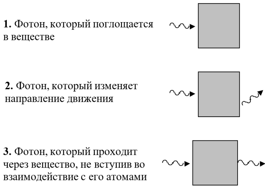
Рис. 8. Виды прохождений (1, 2, 3) рентгеновских квантов через вещество
