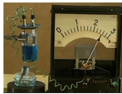
Рис. 4. Зависимость электропроводности электролита от температуры
