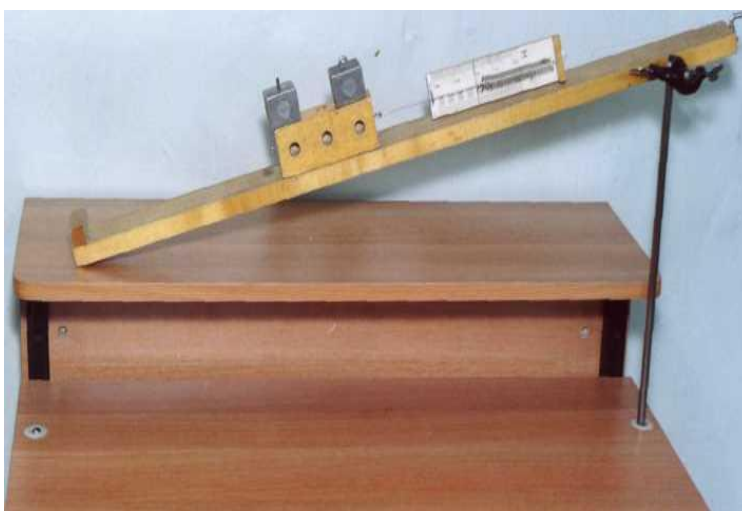
Рис. Определение КПД наклонной плоскости
